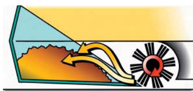
Princip zametací lopaty: stupeň naplnění 40-50%
