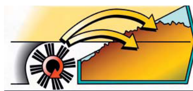
Princip zametání pomocí přehození: stupeň naplnění 85-100%
