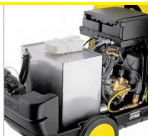
Důsledkem oddělení rychlotopné komory a zásobníku teplé vody je, že vřelá voda ke stříkání je k dispozici ve velmi krátké době. Směsný ventil na obslužném panelu misí vřelou vodu se studenou vodou ze zásobníku s plovákem. Zásoba vřelé vody se v případě potřeby nízkých pracovních teplot nespotřebuje.
