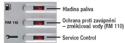
**Service Control:** Všechna provozní data jsou shromažďována a intervaly údržby a také poruchy jsou signalizovány formou kódu na samostatném ukazateli LED. Konkrétně je to přehřátí motoru, nedostatek vody, porucha hořáku, prosak, příliš vysoké teploty spalin a bezpečnostní odpojení čerpadla.
