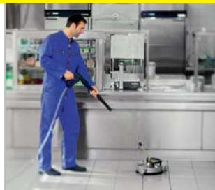
Plošné čištění bez rozstříkující se vody ve vnitřním prostoru čističem ploch FR 30 (pol. 9).
