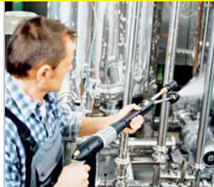
Sada Inno Foam k čištění stáčecích zařízení.
