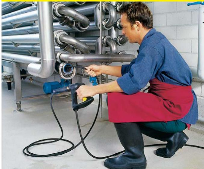
Čištění potrubí s vhodným příslušenstvím pro Váš vysokotlaký čistič.
