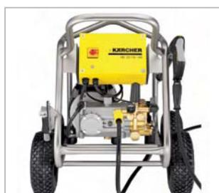
**HD 2000 Super – dvojnásobná čistota:** Konstruované pro provoz s dvěma pracovními nástavci (volitelné vybavení), dvě výkonné čerpací soupravy s motorem a s časově posunutým rozběhem zaručují optimální využití výkonu. Extra velká, integrovaná nádržka na čisticí prostředky (10 l) garantuje dlouhou pracovní dobu bez přerušení.
