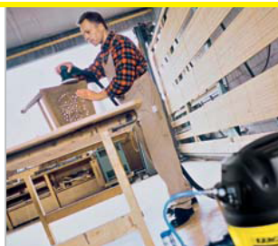
Sací hadice s integrovaným přívodem stlačeného vzduchu pro nástroje pracující se stlačeným vzduchem. (pol. 1 -2)
